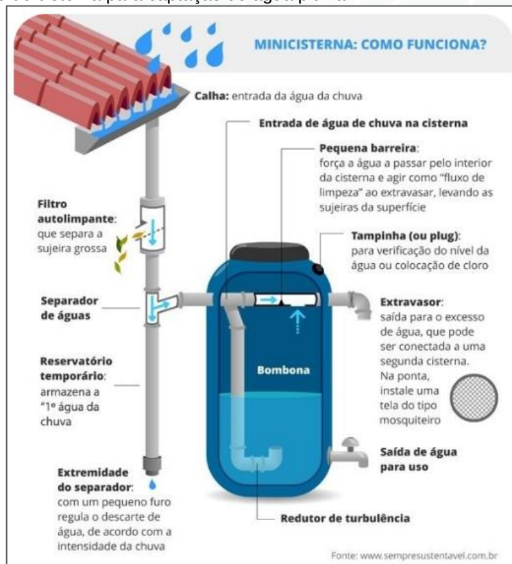
Figura 116: Modelo de cisterna para captação de água pluvial.
