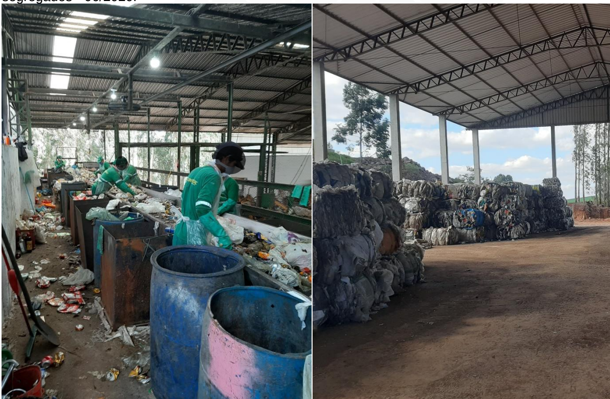
Figura 63: Esteira de separação dos resíduos e área coberta para armazenamentos dos resíduos segregados - 06/2020.
